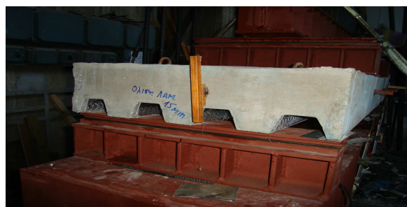
Φωτ. 1.: Ολίσθηση σύμμικτης πλάκας
