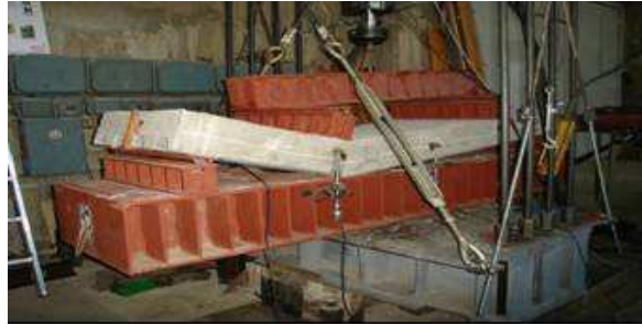
Φωτ. 2.: Αστοχία σύμμικτης πλάκας
