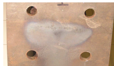
Φωτ.4 - Ίχνος θερμοκρασιακών μεταβολών
