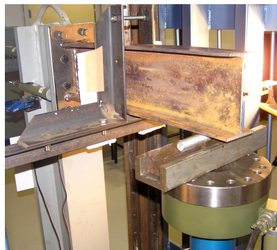
Φωτ.1- Πλευρική εξασφάλιση
