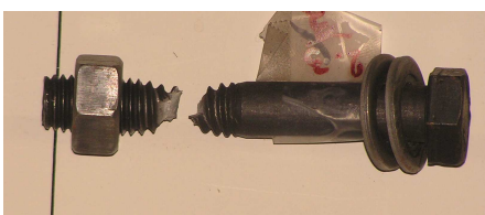
Φωτ.3 - Αστοχία κοχλία
