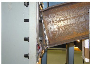
Φωτ.2 - Σύγκριση πειραματικής και παραμετρικής σύνδεσης στη φάση αστοχίας
