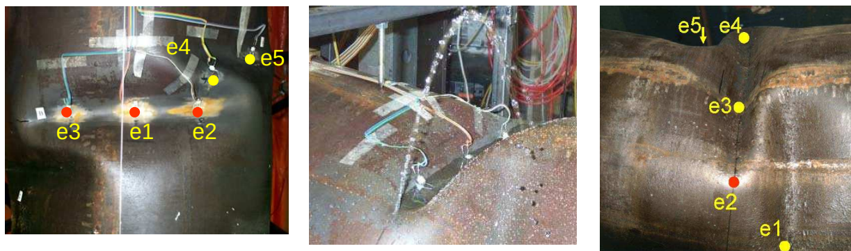
Εικόνα 2. (2a) Ύβωση στο δοκίμιο 1 προ της επιβολής κόπωσης και σημεία τοποθέτησης μηχανοσυστοιχιών. (2b) αστοχία δοκιμίου 1 λόγω κόπωσης. (2c) Ύβωση στο δοκίμιο 2, πριν την επιβολή κόπωσης και διάταξη μηχανοσυστοιχιών. Η αστοχία παρατηρήθηκε πολύ κοντά στο μηχανοσυστοιχία e4.
