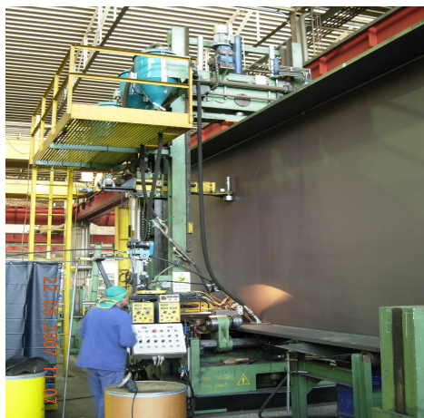
Φωτ. 4 Συγκόλληση Κάτω πέλματος δοκού με S.A.W.
