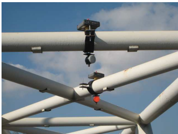
Σχήμα 3: Αριστερά: Η διάταξη των δεκτών GPS (πάνω από τη δοκό) και των ανακλαστήρων (κάτω από τη δοκό) σε δύο γειτονικές θέσεις στο πάνω μέρος του δικτύματος, στη μέση του κεντρικού ανοίγματος. Δεξιά: Ένα από τα δύο RTS που χρησιμοποιήθηκαν στοχεύει έναν από τους ανακλαστήρες και καταγράφει την κίνηση της γέφυρας.
