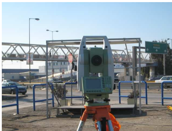
Σχήμα 3: Αριστερά: Η διάταξη των δεκτών GPS (πάνω από τη δοκό) και των ανακλαστήρων (κάτω από τη δοκό) σε δύο γειτονικές θέσεις στο πάνω μέρος του δικτύματος, στη μέση του κεντρικού ανοίγματος. Δεξιά: Ένα από τα δύο RTS που χρησιμοποιήθηκαν στοχεύει έναν από τους ανακλαστήρες και καταγράφει την κίνηση της γέφυρας.
