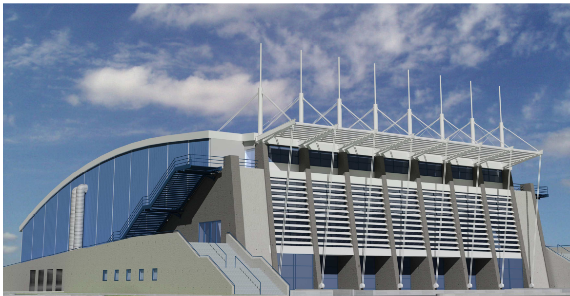
Εικ.10 Όψη του γυμναστήριου στην τελική του μορφή. Διακρίνονται οι τένοντες και το σύστημα ανάρτησης.
