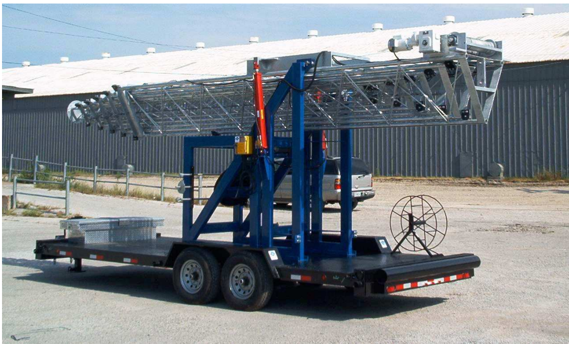
Φωτ. :5 Δικτυωτός ιστός ύψους 29 m, τριγωνικής διατομής, αυτοφερόμενος επί ειδικού οχήματος
