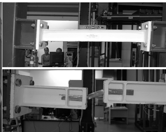
Φωτ. 2. Παραμορφωμένες δοκοί ακαμψίας (IPE100 – 2 Bars 12.5/25mm)
