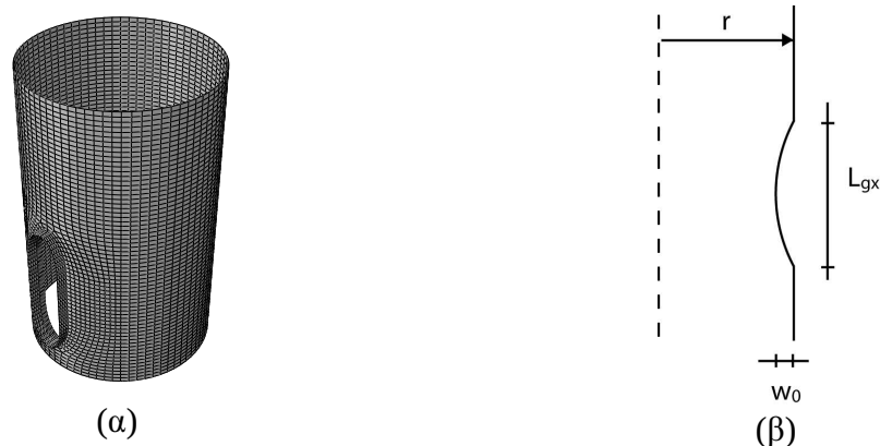
Σχ. 5: (α) Προσομοίωμα πεπερασμένων στοιχείων και (β) μορφή ατέλειας στις αναλύσεις GMNIA ( L_{gx} = 1,1257m , w_0 = 0,0180m )
