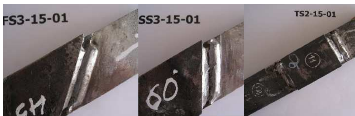
Σχ.4: Τυπική μορφή αστοχίας δοκιμίων
