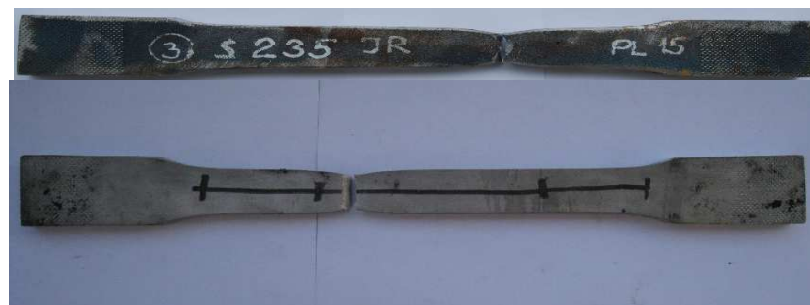
Σχ.2: Τυπική μορφή αστοχίας δοκιμών
