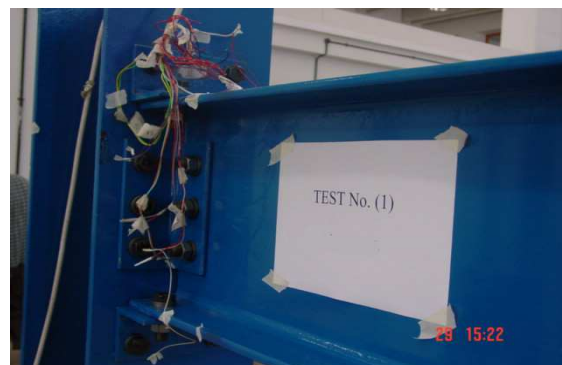
Εικ. 2 Πειραματική διάταξη της σύνδεσης
