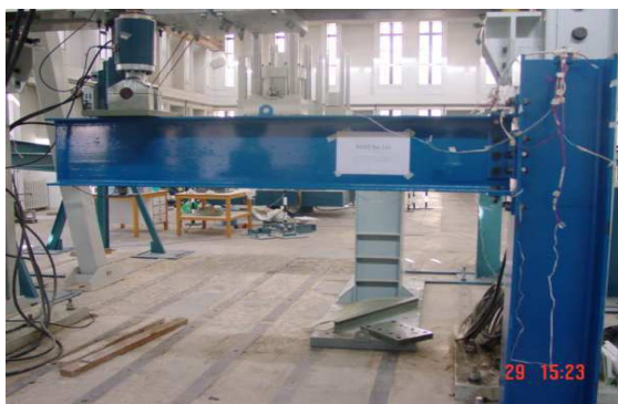
Εικ. 1 Πειραματική διάταξη της σύνδεσης
