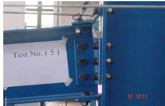
Εικ. 4 Διαχωρισμός γωνιακών πέλματος και κορμού
