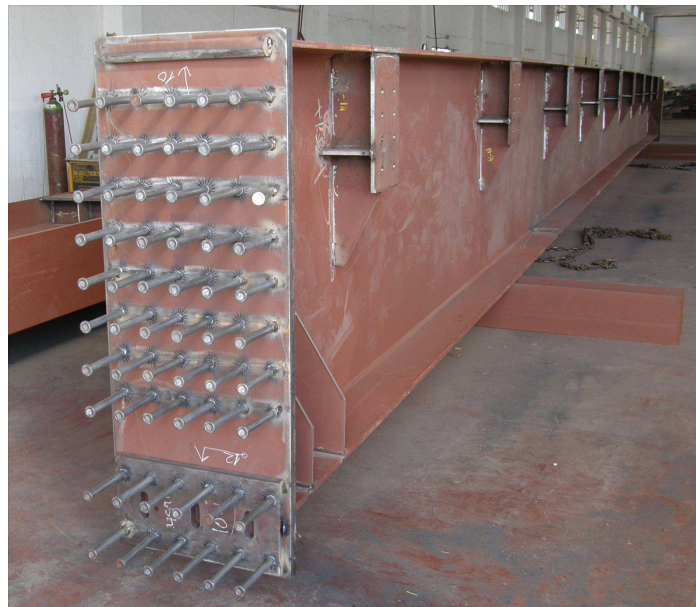
Φωτ. 2: Μετωπική πλάκα δοκού στο στάδιο της παραγωγής
