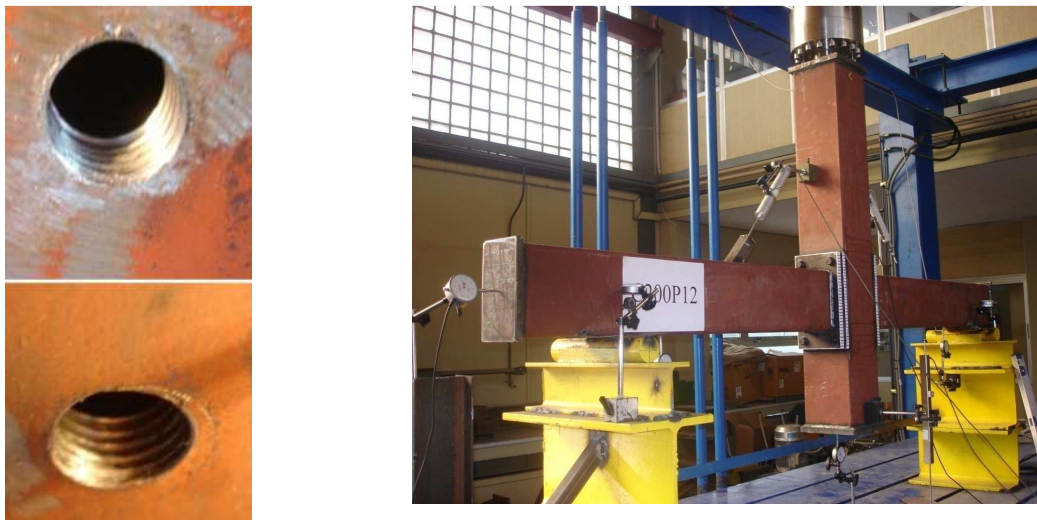
φωτ.1: Χάραξη σπειρώματος στα τοιχώματα των διατομών και πειραματική διάταξη
