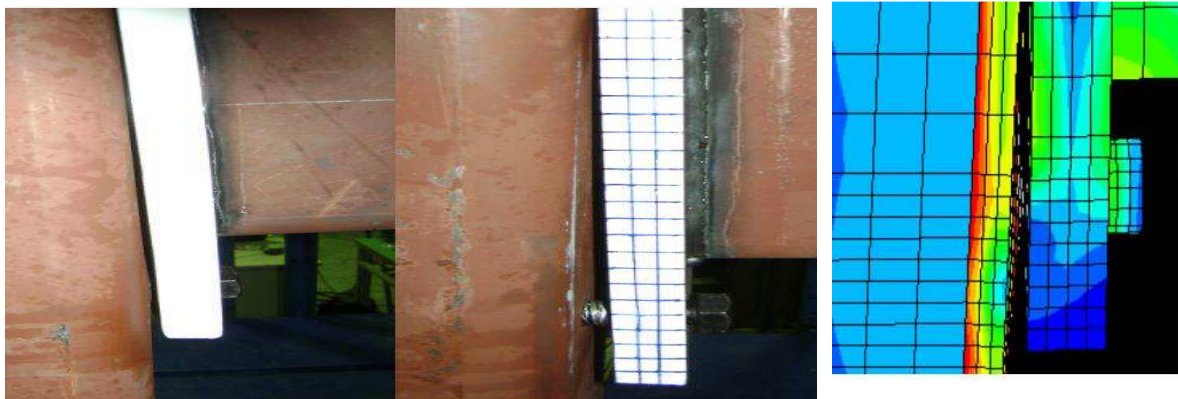
φωτ. 2: Σπάσιμο σπειρώματος τοιχώματος διατομής & εξόλκευση κοχλιών C220P0
