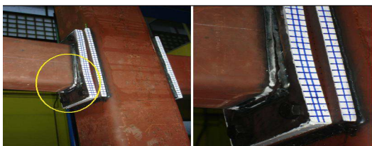
φωτ. 3: Αστοχία συγκόλλησης πειραματικού C220P12
