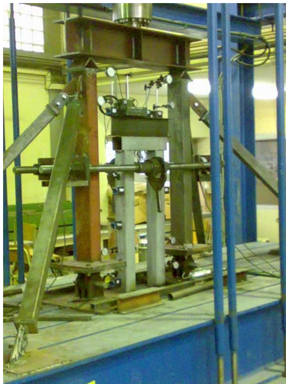
Φωτ. 1. Γενική άποψη της πειραματικής διάταξης με τα σύμμικτα υποστυλώματα
