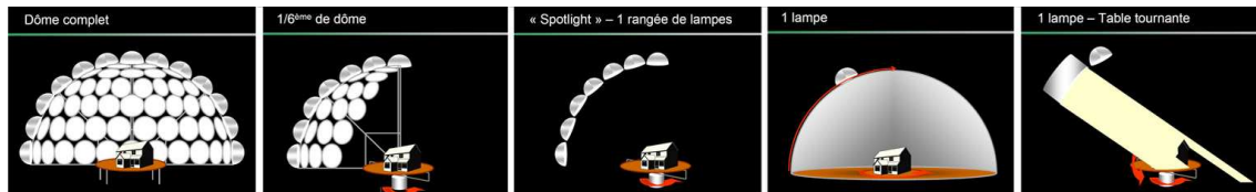
Εικ. 1 – Διατάξεις τεχνητών ουρανών (από Bodart et al. [2])
