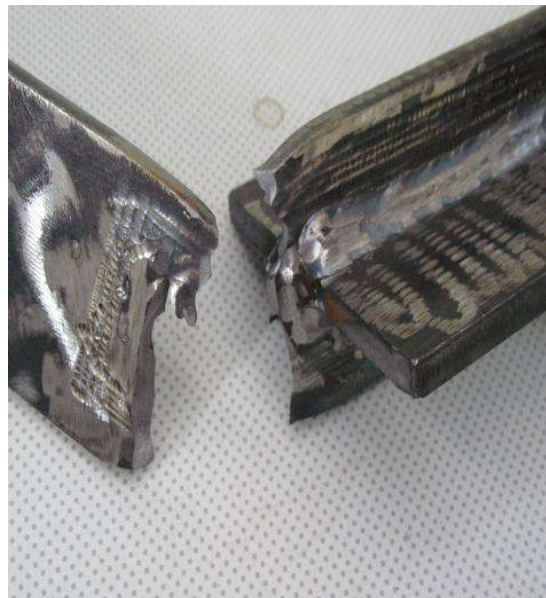
Φωτ. 5- α) «Διάρκεια ζωής» δοκιμίων αναφοράς και της συγκολλητής σύνδεσης πριν και μετά απο UIT. β) Θέση αστοχίας της συγκολλητής σύνδεσης.
