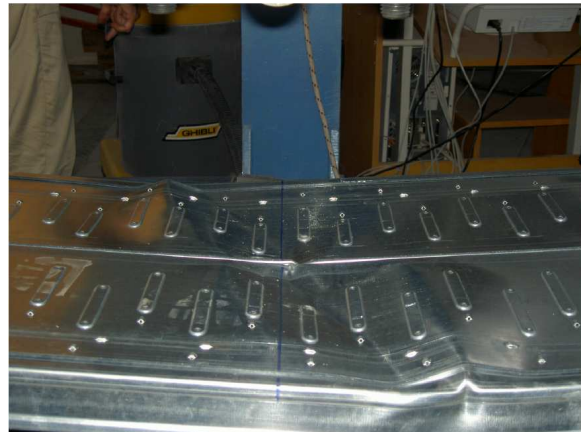
Φωτ. 4: Μορφή αστοχίας του δοκιμίου της Φωτ.3.
