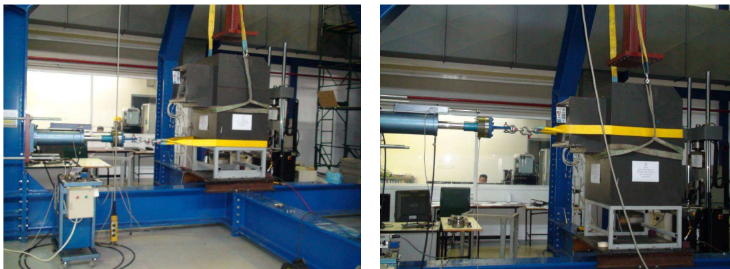
Σχ. 3. Πειραματική διάταξη για μικρό (αριστερά) και μεγάλο (δεξιά) ύψος επιβολής φορτίου
