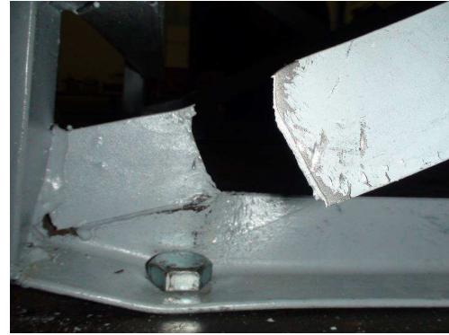
Σχ. 7. Καμπύλη σχετικής δύναμης-μετατόπισης τύπου SL Σχ. 8. Αστοχία εφελκυσμένης διαγωνίου
