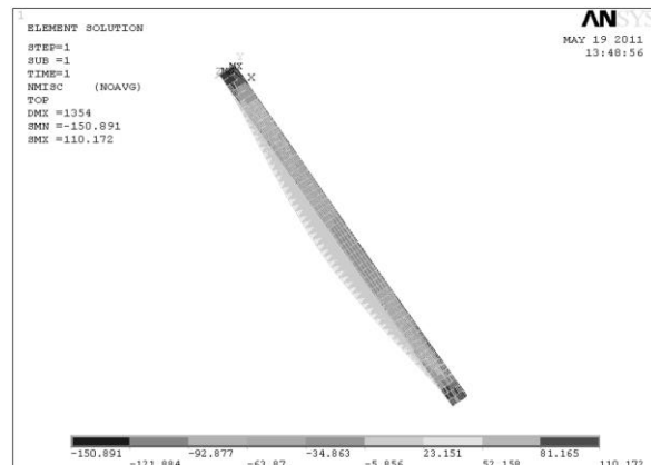
Σχήμα 5β. 3-D FEM, COMB3 1 ροπές κάμψης άνω φορέα
