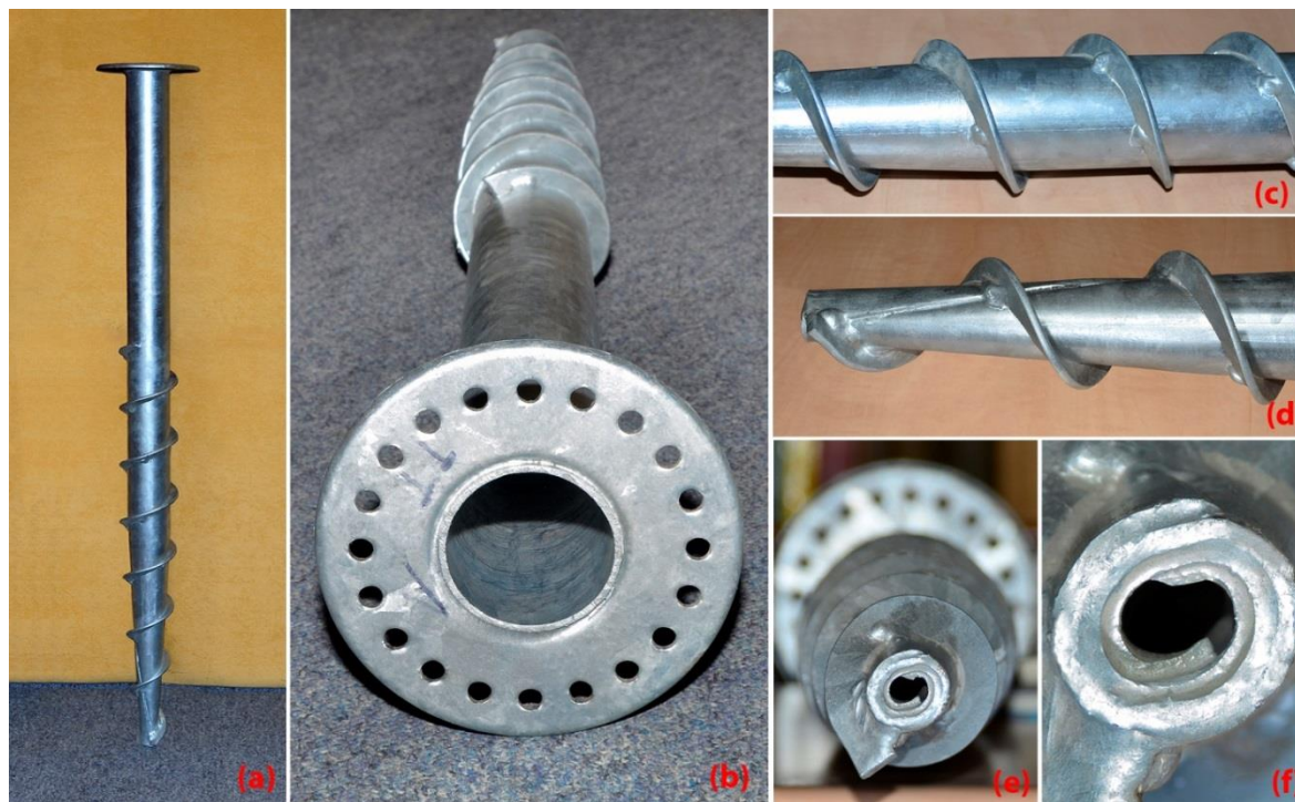
Φωτ. 1: Γεώβίδα συνολικού μήκους 1,20 m, (a) όψη, (b) κεφαλή, (c) συναρμογή κυλινδρικού και κωνοειδούς τμήματος, (d) κωνοειδές τμήμα, (e) ρύγχος και περύγιο, (f) απόληξη ρύγχους, διαμέτρου 25 mm, όπου διακρίνονται οι δύο Αρχιμήδειες σπείρες.
