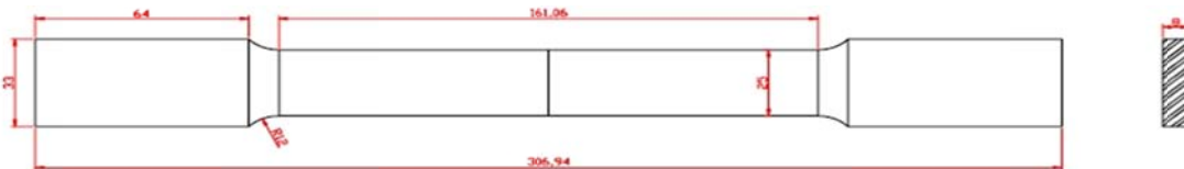
Σχ. 1 Διαστάσεις ηλεκτροσυγκολλημένων δοκιμίων
