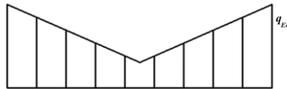
Σχήμα 9 Μεταβολή μέγιστης διατμητικής ροής κατά μήκος δοκού
