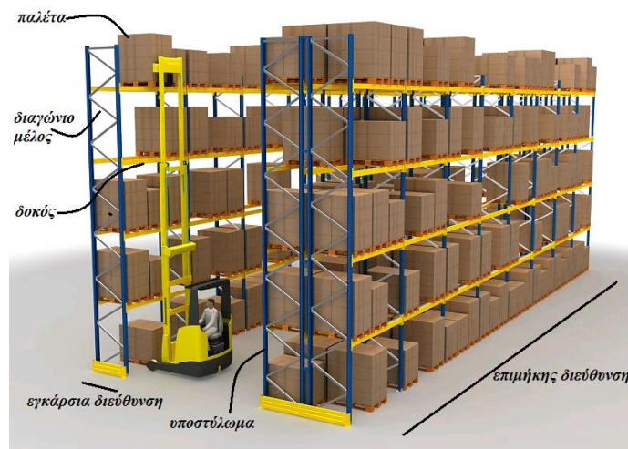
Σχήμα. 1 Τυπική μορφή συστήματος αποθήκευσης
