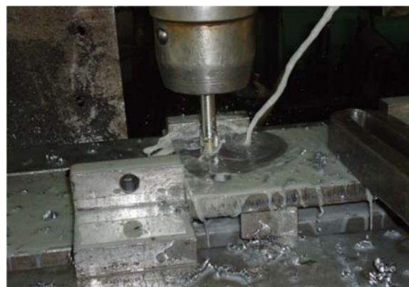
Φωτ. 7: Χάραξης σπειρωμάτων στις άντυγες των οπών.
