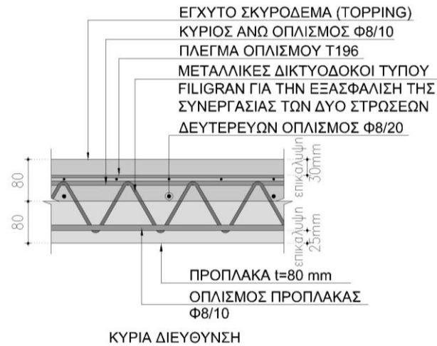
Σχημ. 3- Τυπικές τομές γεωμετρίας και οπλισμού πλάκας δαπέδου
