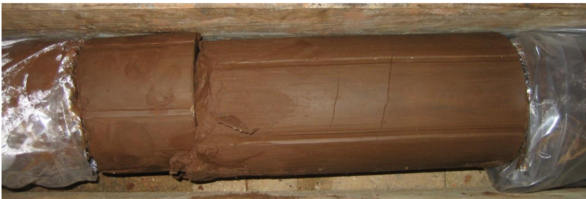
Εικ. 5: Λεπτομέρεια του ανώτερου στρώματος της μαλακής έως μέτριας συνεκτικότητας αργίλου. Το έδαφος αυτό εμφανίζεται στα ανώτερα στρώματα της ζώνης θεμελίωσης του έργου(«[I]»).
