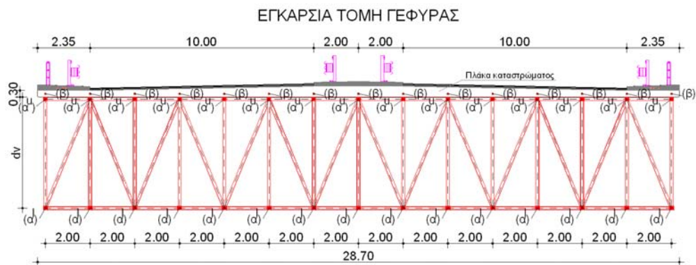
Σχ. 3. Τυπική διατομή του μοντέλου γέφυρας (τύπου MBN) στο μέσον του ανοίγματος.
