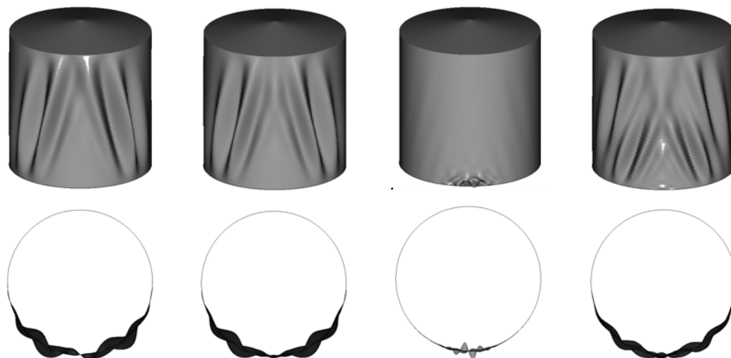
Σχ. 3: Τυπικές ιδιομορφές θερμικού λυγισμού για την δεξαμενή A (1 η , 3 η , 5 η και 7 η αντίστοιχα).
