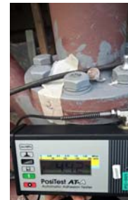
Φωτ. 32 - Έλεγχος πρόσφυσης σε κοχλία
