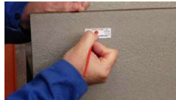
Φωτ. 30 - Έλεγχος τραχύτητας αμμοβολής
