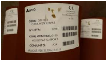
Φωτ. 29 - Σήμανση CE και ιχνηλασιμότητα
