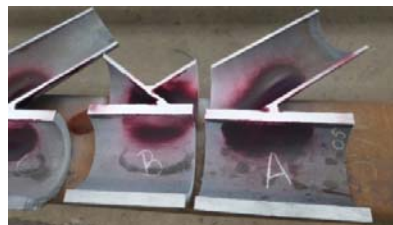
Φωτ. 26 - Branch joint W.P.Q.R. - Έλεγχος PT πριν το Macro
