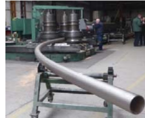
Φωτ. 14 - Καμπύλωση πέλματος CHS δικτυώματος
