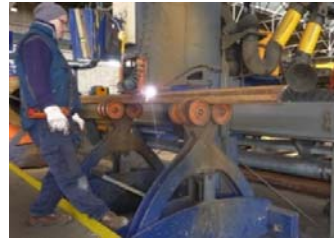
Φωτ. 12 - Αυτόματη κοπή πλάσμα CHS
