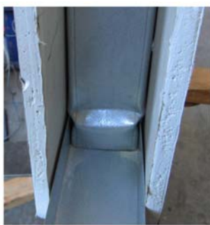
Σχ. 9: Τοπικός λυγισμός στη βάση του ορθοστάτη (αριστερά) και δρόμος ισορροπίας φορτίου-μετακίνησης στην κορυφή (δεξιά)
