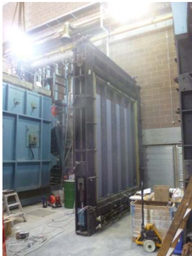
Σχ. 2: Ενδεικτική τοιχοποιία στο πλαίσιο φόρτισης (αριστερά) και στο τέλος δοκιμής (δεξιά).
