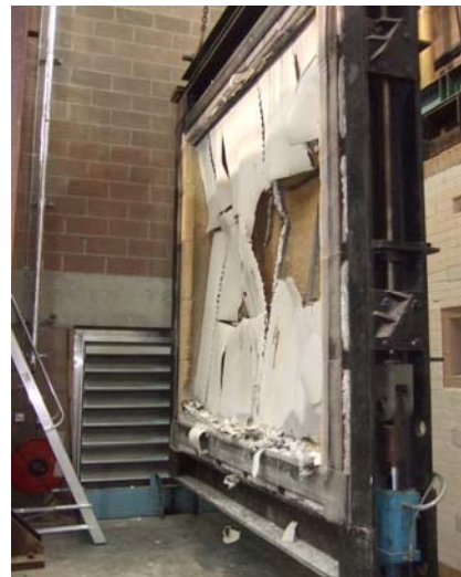
Σχ. 2: Ενδεικτική τοιχοποιία στο πλαίσιο φόρτισης (αριστερά) και στο τέλος δοκιμής (δεξιά).
