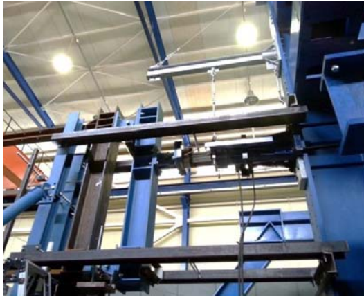
Φωτ. 3 Κατακόρυφη δοκός κατανομής φορτίου εμβόλου και σύστημα πλευρικής εξασφάλισής της
