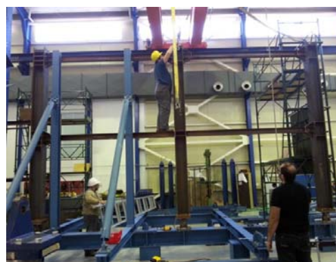
Φωτ. 2 Μεταφορά των δοκιμίων και συναρμολόγηση της πειραματικής διάταξης
