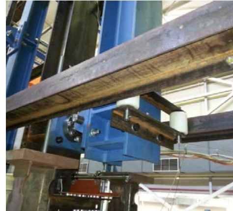
Φωτ. 3 Κατακόρυφη δοκός κατανομής φορτίου εμβόλου και σύστημα πλευρικής εξασφάλισής της
