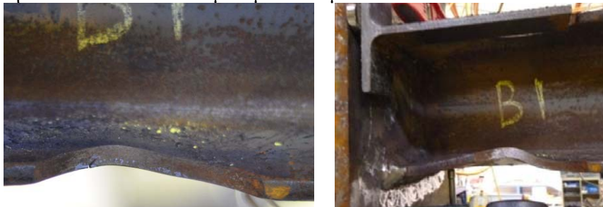
Φωτ. 5 Σχηματισμός ρωγμών και τοπικός λυγισμός σε κρίσιμη διατομή με RBS
