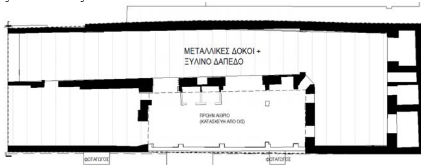
Σχήμα 1 Κάτοψη του τυπικού ορόφου του υφιστάμενου κτιρίου.
